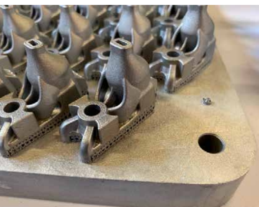
Kuva 1. Suomalaisen palveluntarjoajan 3D-tulostama pieni liimanlevityssuutin, jonka kappalehinta 3D-tulostettuna sarjatuotannossa 27,9 €. Materiaali: AISI10Mg. (Kuva: Korpela)
